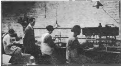
De lampen worden van hulzen voorzien.
