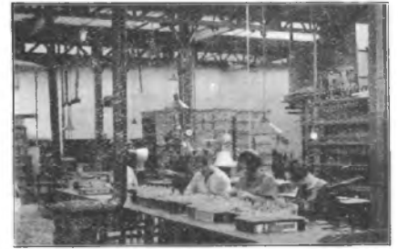
Het inzetten van de gloeidraden.
